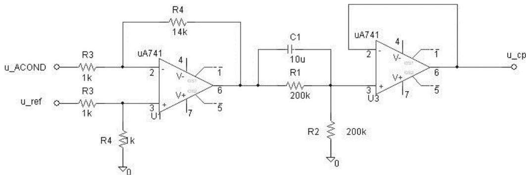
5. Dibujar el diagrama de Bode de la cadena abierta del sistema de control del apartado anterior. Determinar aproximadamente el margen de fase, margen de ganancia y la respuesta temporal del sistema ante una entrada en escalón unitario.
